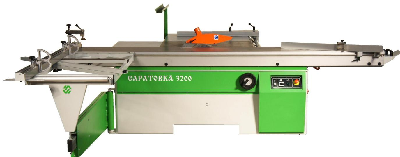
Форматно-раскроечный станок САРАТОВКА 3200, обеспечивает высокую стабильность и точность работы на протяжении всего срока эксплуатации. Данный станок предназначен для чистого раскроя щитов из ДСП, МДФ с различными покрытиями, массива древесины, тонких листовых материалов и профилей.
